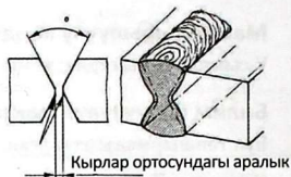
4-сүр. Эки V-сымал тигишти даярдоо
