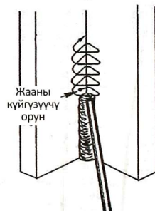
1-сүр. Тигиштин негизин ширетүүдө электродду кийирүү
