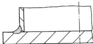
3-сүр. Жакшы ширетилген бурчтук тигиш
